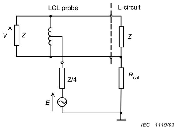
NOTE  $LCL_L = 20 \lg \left| \frac{(R_{sym} // Z) + 4R_{cal} + Z}{2(R_{sym} // Z)} \right|$  dB
