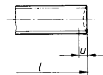
As-rolled end Brut de roulage Накатанный конец
