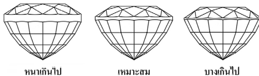
รูปที่ ค.5 แสดงความหนาของขอบไฟลิน (ข้อ ค.5.4.1)
