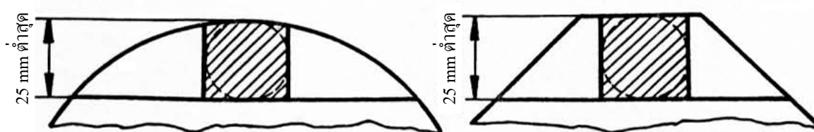
รูปที่ จ.7 ชิ้นทดสอบที่มีภาคตัดรูปกลมหรือหกเหลี่ยม
