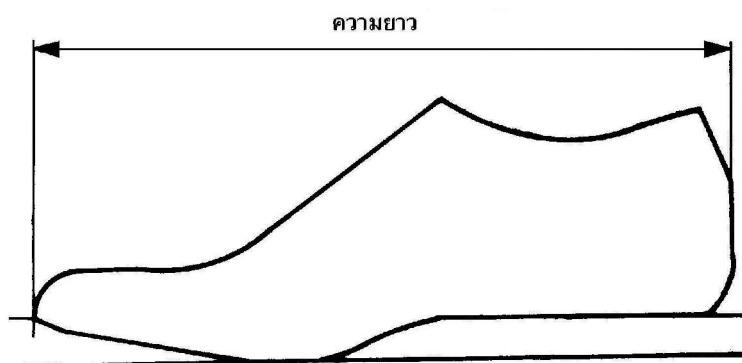
รูปที่ 3 วิธีวัดขนาดของหุ่นรองเท้า (ข้อ 4.1)
