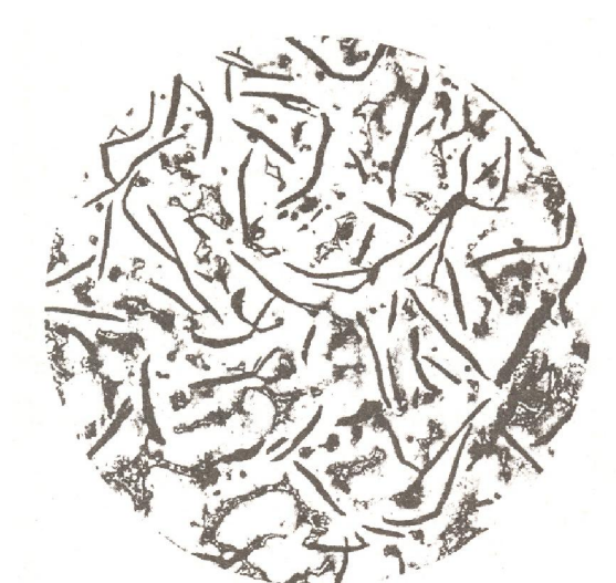
รูปที่ 1 โครงสร้างจุลภาคของเหล็กหล่อเทา (ขยาย 100 เท่า) (ข้อ 2.2)
