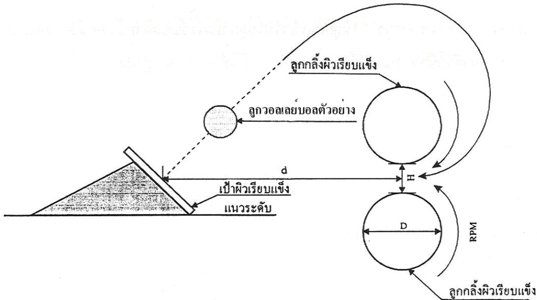
รูปที่ 2 แสดงมิติและอุปกรณ์ของเครื่องยิงลูกบอล
