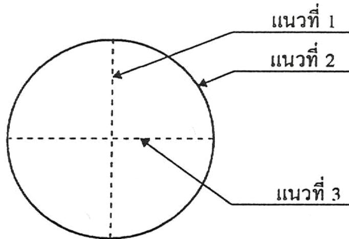
รูปที่ 1 แนวที่กำหนดสำหรับวัดเส้นรอบวง
